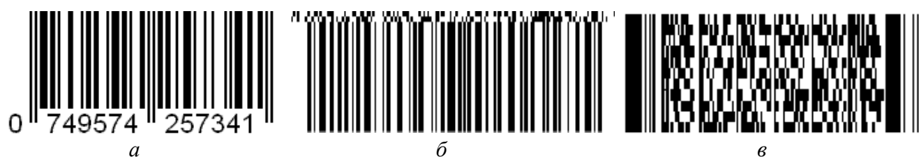
Рис. 1. Основные типы штрих-кодов, используемые для маркировки продукции: линейный EAN-13 (а), двумерный UCC/EAN-128 (б) и матричный PDF-417 (в)
