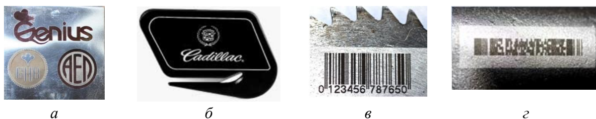
Рис. 4. Примеры нанесения на изделия из металлов (а-в) и полимеров (г) логотипа предприятия (а, б), линейного (в) и двумерного (г) штрих-кода
