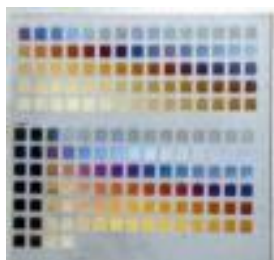
Рис. 5. Тестовая таблица на ВТ1-0, полученная при I = 18 А, F = 20 \dots 35 кГц, V = 5 \dots 25 мм/с
