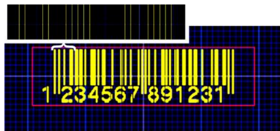
Рис. 6. Изображение штрих-кода на фоне миллиметровой сетки, подготовленное к маркировке в программе «LTCEdit»
