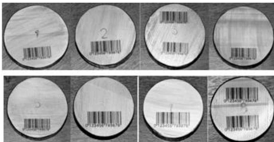
Рис. 8. Внешний вид поверхности образцов после нанесения штрих-кода
