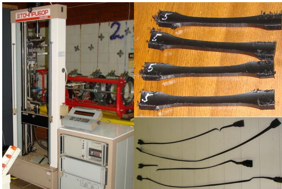
Рисунок 3. Общий вид разрывной машины и образцов-лопаток (до и после испытаний) (представлено из работы [5])
