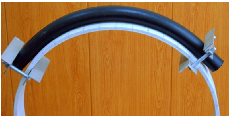
Рисунок 1. Типовой вид полиэтиленовой трубы под нагрузкой (представлено из работы [4])
