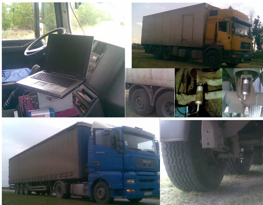
Рис. 6. Экспериментальные замеры воздействия транспортных средств на дорожную конструкцию
