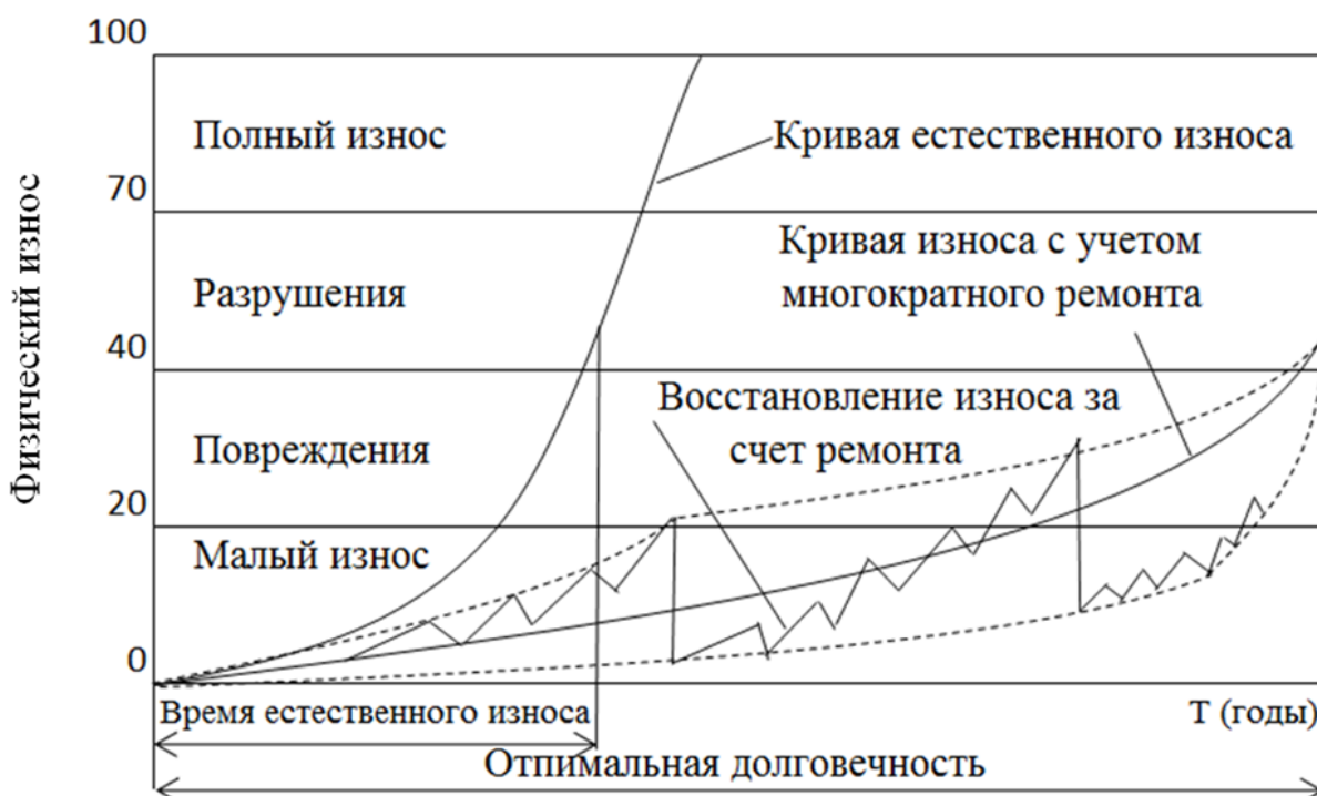
Рисунок 2. Восстановление эксплуатационного ресурса путем проведения капитальных ремонтов и оптимальная долговечность здания (по данным [1])
