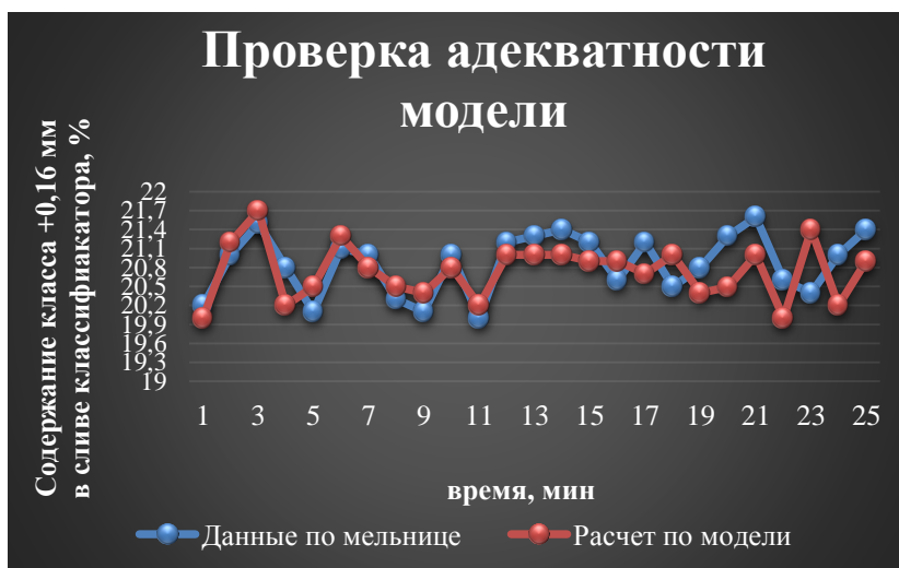
Рисунок 7. Прогнозное (по модели) и измеренное изменение содержание класса крупности +0,16 мм в сливе классификатора (составлено автором)
