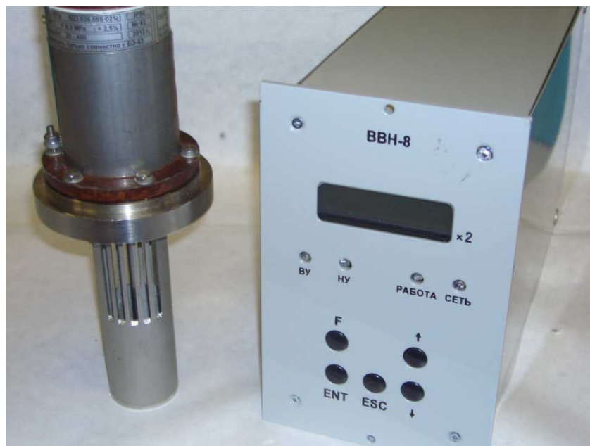
Рис. 4. Вискозиметр вибрационный ВВН-8 с блоком управления
