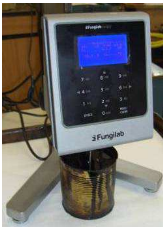
Рис. 1. Общий вид ротационного вискозиметра Fungilab Expert
