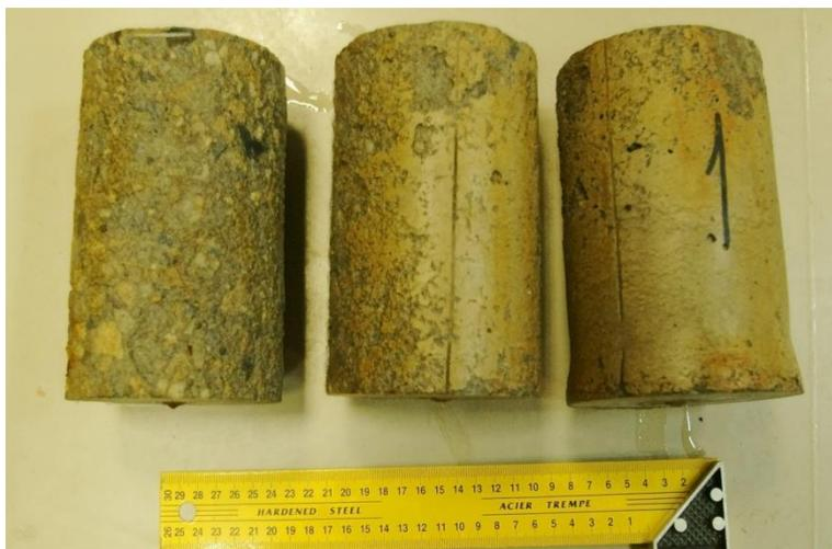
**Рисунок 7.** Образцы бетона с каркасной структурой после 50 циклов замораживания-оттаивания по 2 методу ГОСТ 10060 (разработано автором)
