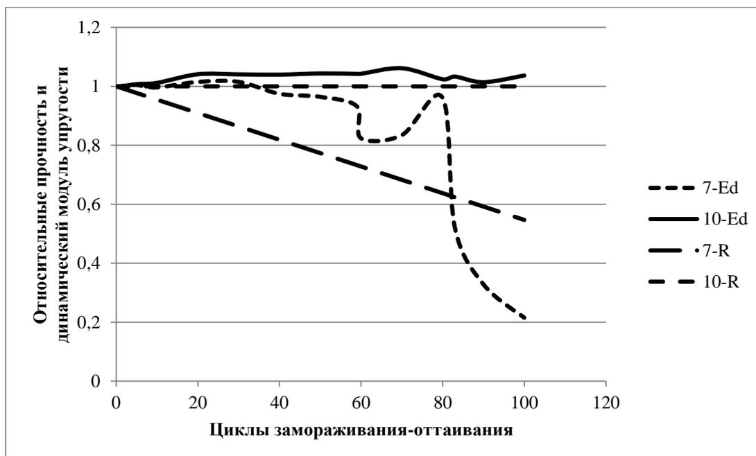
**Рисунок 5.** Изменение прочности на сжатие  $R$  и динамического модуля упругости  $E_d$  бетона с нерациональной (7) и рациональной (10) макроструктурой по [14] при циклическом замораживании-оттаивании по 2 методу ГОСТ 10060 (разработано автором)
