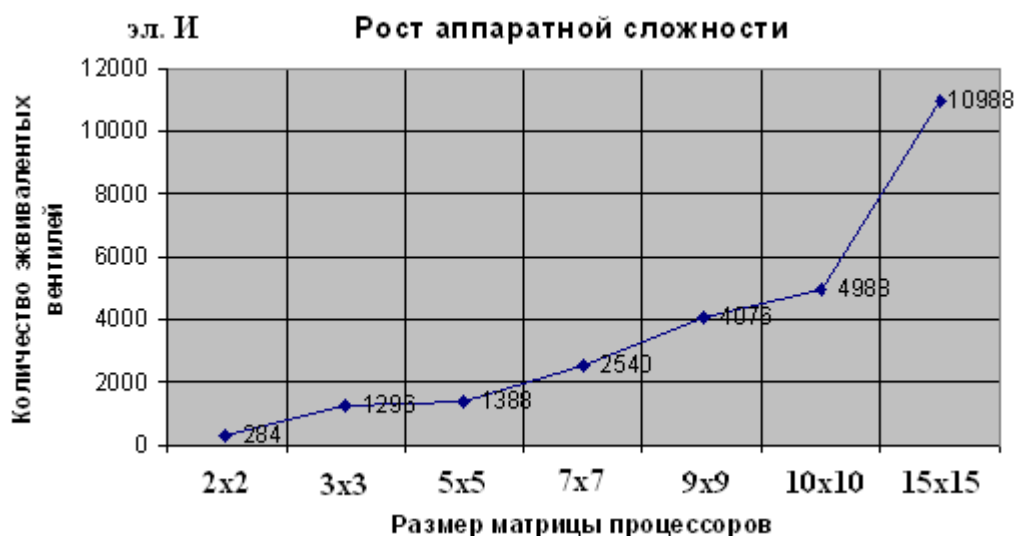
Рис. 6. Зависимость роста аппаратной сложности от размерности матрицы процессоров
