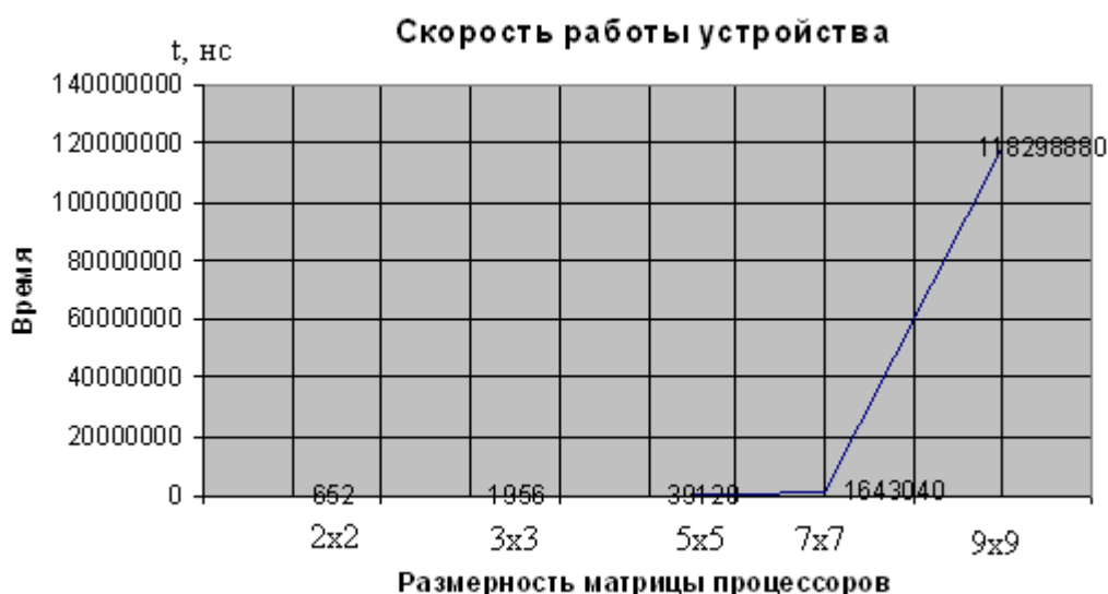
Рис. 5. Зависимость скорости работы устройства от размерности матрицы процессоров
