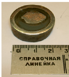
Рис. 1. Образец для измерения твердости в сечении арматуры
