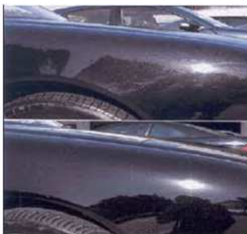
Рис. 6. Новое прозрачное нанопокрывтие (снизу) в сравнении с традиционной окраской (сверху) после 5 лет практических испытаний и 60 моек
